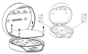
Dévissez les 4 vis du couvercle des piles et insérez les 4 piles dans l'emplacement prévu.
