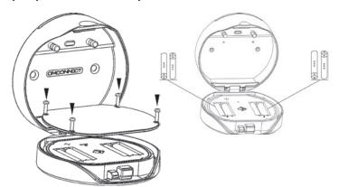
Dévissez les 4 vis du couvercle des piles et insérez les 4 piles dans l'emplacement prévu.
